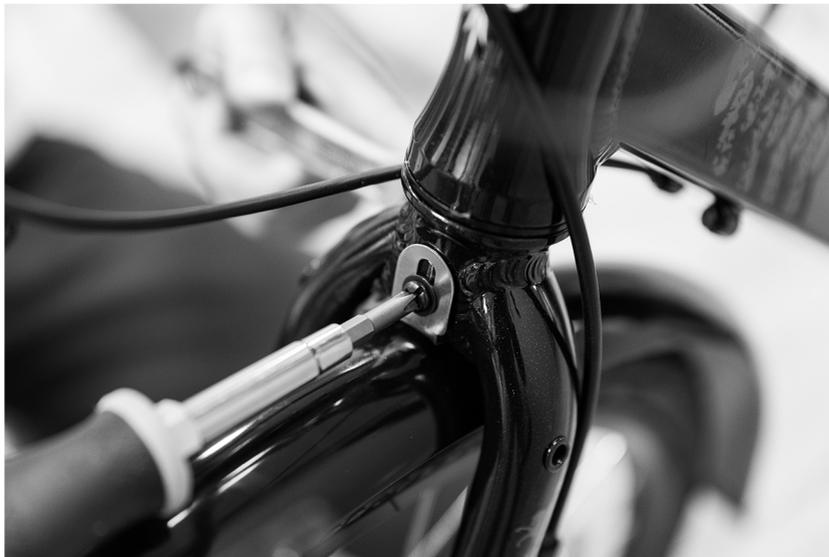
Suportii aripii se vor fixa pe aripă cu ajutorul elementelor de plastic și a suruburilor de aferențe (acestea se introduc în aripă prin forare)
